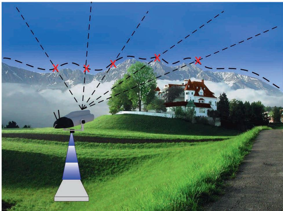
@wf® se instala en una torreta a una altura conveniente por encima de obstáculos cercanos, para garantizar su buen funcionamiento y seguridad, al tiempo que se logra una óptima posición para enviar el haz de luz sobre la línea del horizonte, sobre la base de las coordenadas previamente establecidas que garantizan la detección de columnas de humo o partículas de polvo o fugas de contaminantes a la atmósfera.
